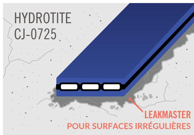
Les surfaces de béton rendues irrégulières à la suite de l'usage de marteaux-piqueurs ou d'un vieillissement prononcé peuvent être rendues lisses. L'application d'un cordon de Leakmaster suffisant au béton sec et rugueux permet de produire une surface plane et lisse. Le profil Hydrotite doit être mis en place dans les 4 heures qui suivent.
